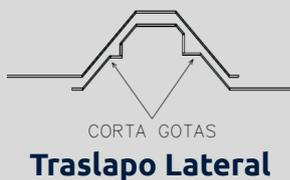
La importancia del **Corta Gotas** es que **minimiza la posibilidad de filtración de agua**, que se da por fenómeno de capilaridad en donde el agua sube en contra sentido de la gravedad entre lámina y lámina y se precipita al interior del volumen. Nuestro **Corta gotas** impide que se presente este fenómeno y evita el uso de sellos adicionales.
